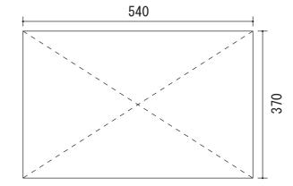
SBT-20N1W-in 開口寸法 540(W)×370(H) 奥行は壁面から65mm以上開ける事
